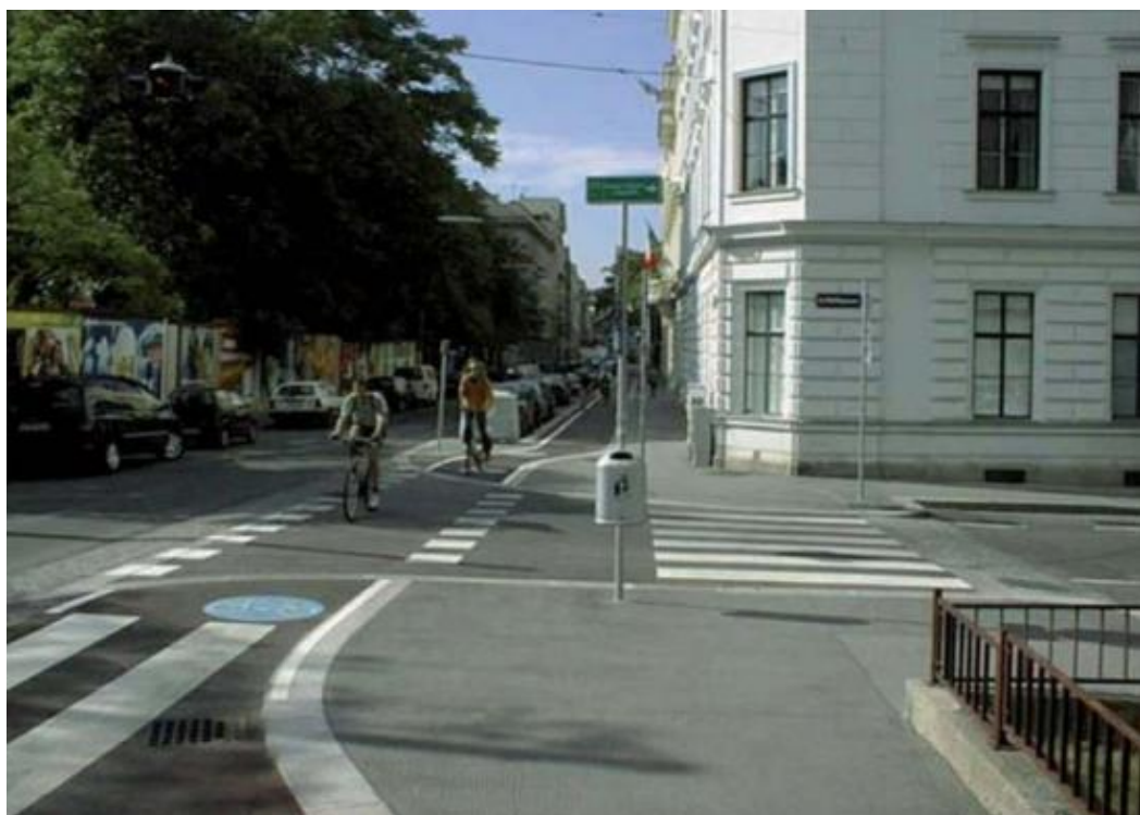
Abbildung 71: Best Practice Beispiel für eine optimale Bodenmarkierungs-Lösung im Bereich von Knotenpunkten: Von der Fahrbahn nicht abgesetzte Radfahrerüberfahrt (Quelle: FSV 2014)
