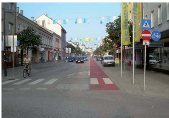
Abbildung 10: Farblich hervorgehobener Radfahrstreifens gegen die Einbahn neben Parkstreifen (Quelle: FSV 2014)
