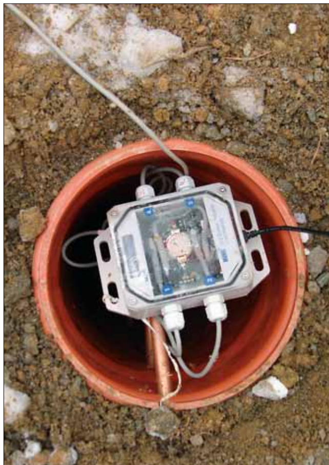
Die Temperaturmessung wird mit Fühlern an der Oberfläche und in drei verschiedenen Tiefen des Straßenaufbaues gemessen (unter der bituminösen Tragschicht, in der ungebundenen unteren Tragschicht sowie unter dem Unterbauplanum).
