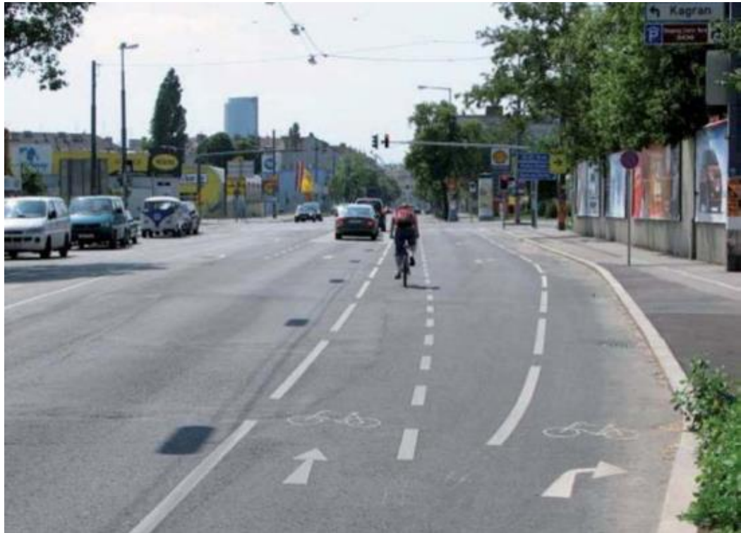
Abbildung 79: Best Practice Beispiel für eine optimale Bodenmarkierungs-Lösung im Bereich von Knotenpunkten: Vorsortierung geradeausfahrender und rechtsabbiegender Radfahrer vor Kreuzung (Quelle: FSV 2014)
