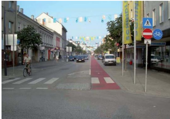
Abbildung 10: Farblich hervorgehobener Radfahrstreifen gegen die Einbahn neben Parkstreifen (Quelle: FSV 2014)
