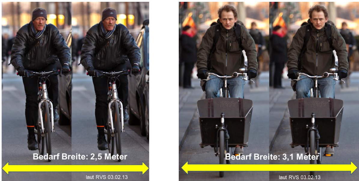
Abbildung 16: Vergleich des Lichtraums verschiedener Fahrradtypen auf Basis von Mindestbreiten nach RVS 03.02.13 (eigene Bearbeitung, 2023)
