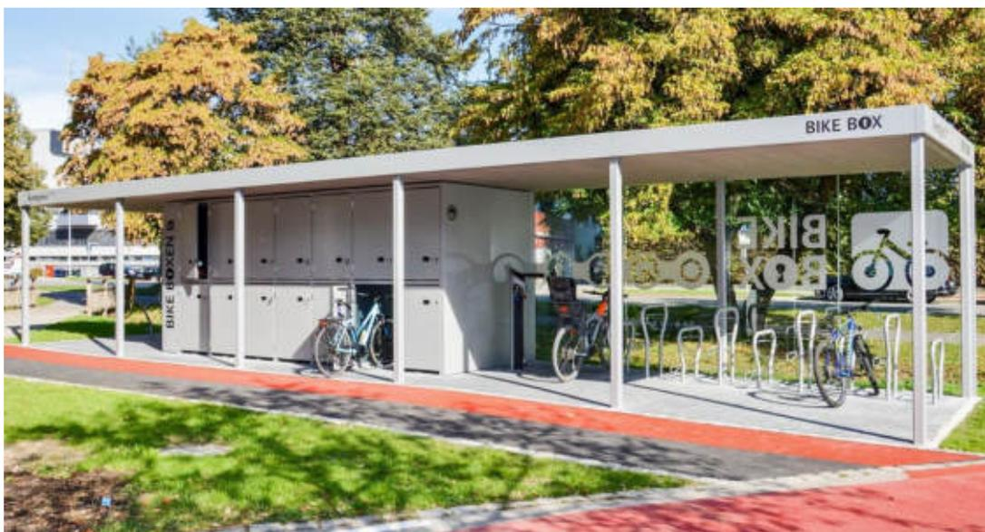
Abbildung 16: „Bike Box“ - Fahrradabstellanlage inkl. Anlehnbügel, verschleißbaren Fahrrad-Boxen und einer Service-Station (Bildquelle: kempten.de)
